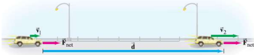
រូប៧.៤៖ កម្លាំងថេរ F_{net} ធ្វើឱ្យរថយន្តប្រែប្រួលល្បឿនពី v_1 ទៅ v_2 ក្នុងបំណងទី d ។ កម្មន្តដែលបំពេញដោយកម្លាំងនេះគឺ W = F_{net}d ។
