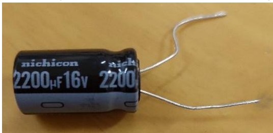
រូប១០.១ កុងដង់សាទ័រអេឡិចត្រូលីត (electrolytic capacitor)
