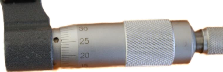
រូបទី១៥ បង្ហាញពីរន្ធសម្រាប់មូលលែតម្រូវឱ្យគំនូសសូន្យនៅលើ Thimble រត់ត្រង់គ្នាជាមួយនឹងបន្ទាត់ដេកនៅលើ Sleeve
