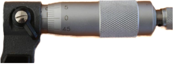
រូបទី១៤ ការពិនិត្យឧបករណ៍មុនពេលវាស់។ គំនូសសូន្យនៅលើ Thimble ត្រូវត្រង់គ្នាជាមួយនឹងបន្ទាត់ដេកដែលនៅលើ Sleeve។
