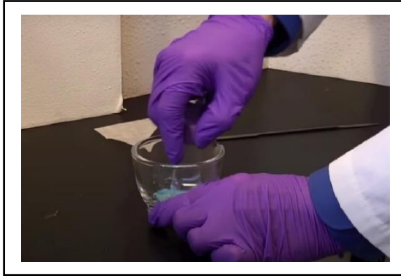
រូបទី៦៩ ការសង្កត់អង្រែដើម្បីកិនកម្ទេចសារធាតុគីមីរឹង
