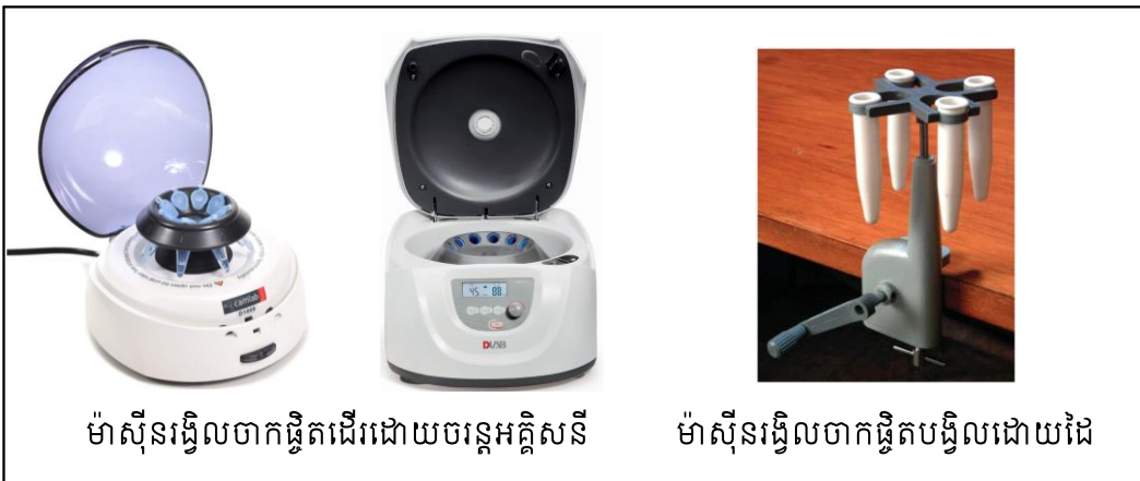
រូបទី៤៧ ប្រភេទម៉ាស៊ីនរង្វិលចាកផ្ចិត(Centrifuge)
