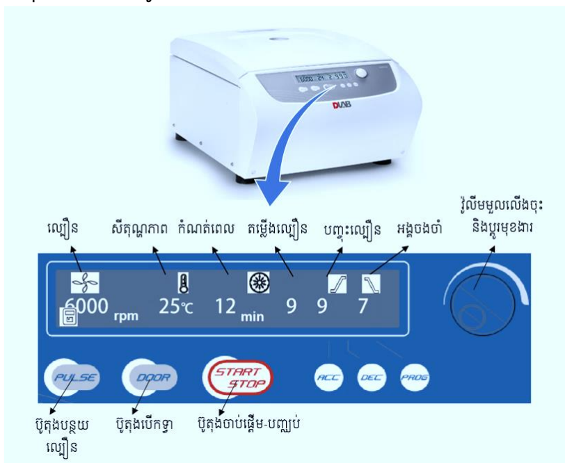
រូប 2. 118 មុខងារនៃការប្រើប្រាស់ម៉ាស៊ីនព្រែកសារធាតុម៉ាក DLAB (Model DM0636) 122
